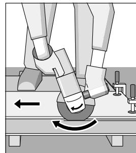
هنگام برش پروفیل ها و لوله های چهارضلعی، بهتر است از کوچکترین ضلع مقطع برش شروع بکار کنید.
