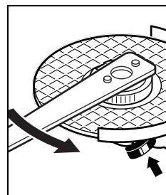
如果安装正确，而且快速螺母未损坏的话，一般可以用手朝著逆时针的转向拧松快速螺母。
