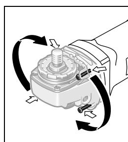
機器操作者可根據需要分段式轉動機頭，每一段的旋轉角度為 90 度。此功能的優點是能夠在特殊的工作狀況下，把起停開關移動到比較容易操作的位置，例如針對左撇子。
