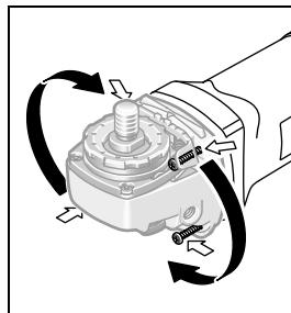
หัวเครื่องสามารถหมุนได้เป็นชั้น ขั้นละ 90° ในลักษณะนี้ ท่านสามารถนำสวิตช์เปิด-ปิดไปยังตำแหน่งที่สะดวกต่อการใช้งาน มากกว่าทำหัวรับสภพ การทำงานที่เฉพาะเจาะจง ด. ย. เช่น สำหรับผู้คนเมืองช้าย
