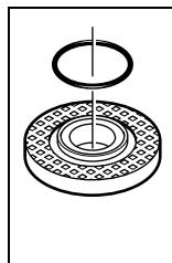
**針對 M 14 主軸的固定法蘭：**在固定法蘭 10 的定心軸環上有一個塑料零件 (O 形環)。如果缺少 O 形環或 O 形環損壞了，務必在繼續使用之前更換固定法蘭 10。
