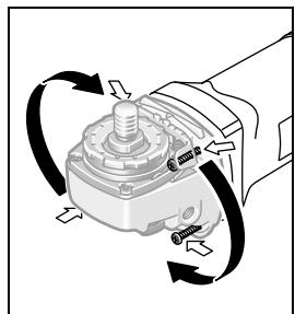
**机壳上拆下机头。** 装回 4 个螺丝并将其拧紧。
