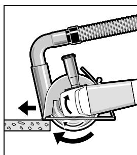
開動電動工具，並把導引裝置的前端放置在工件上。參考工件的物料，適當地施力推進機器。
