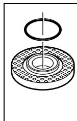
**Flasque de fixation pour broche porte-outil M 14 :** Un joint en plastique (rondelle élastique) est directement monté autour de l'alésage du flasque 10. Au cas où cette rondelle élastique fasse défaut ou qu'elle soit endommagée, il faut absolument remplacer la flasque d'entraînement 10 avant de continuer à l'utiliser l'outil.
