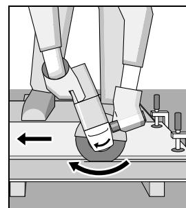
Máy luôn luôn phải được vận hành theo chuyển động mài ở tư thế thẳng đứng. Nếu không như vậy, có sẵn nguy cơ bị **dập mà không điều khiển được máy** ra khỏi mạch cắt.
