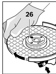
使用主轴锁定键 1 固定主轴。然后朝著顺时针的方向用力地转动砂轮，以便拧紧快速螺母。
