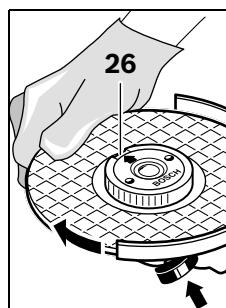
Khóa trục máy mài bằng nút khóa trục máy 1. Để siết chặt dai ốc khóa nhanh, xoay thật chặt đĩa mài theo chiều đồng hồ.
