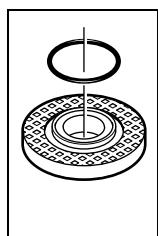
**Bích lắp cho trục máy mài có cỡ M 14:** Chi tiết bằng nhựa (vòng đệm chữ O) được lắp vào vành định tâm của bích lắp 10. **Nếu vòng đệm chữ O bị mất hay bị hư,** phải thay bích lắp 10 trước khi cho máy hoạt động trở lại.
