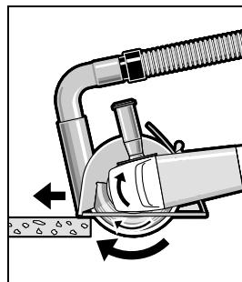
เบ็ดเครื่องทำงาน และ วางแผนหน้าของแผ่นสำหรับตัดน้ำ การตัดน้ำชิ้นงาน เคลื่อน เครื่องไปข้างหน้าด้วย ความเร็วพอประมาณที่ เหมาะสมกับวัสดุชิ้นงานที่ กำลังตัดอยู่
