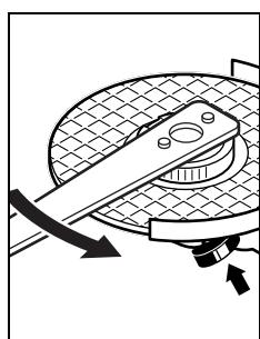
Mur untuk poros kerja yang dibuka dan dikunci dengan tangan yang tidak rusak dan dipasangkan dengan betul, dapat dilepaskan dengan tangan dengan cara memutar ring bergerigi dalam arah yang berlawanan dengan jalannya jarum jam. **Janganlah melepaskan mur untuk poros kerja yang dibuka dan dikunci dengan tangan yang terlalu kencang duduknya dengan tang, melainkan gunakanlah kunci kombi.** Pasangkan kunci kombi 5/6 sebagaimana terlihat pada gambar.
