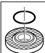
**น้อตกรองจากสำหรับแกนขัด M 14:** ขันพลาสติก (ไอ-ริง) จะติดตั้งอยู่รอบบ่าวยางกลางของน้อตกรองจาก 10 หาด ไอ-ริง หากหรือชำรุด ต้องเปลี่ยน น้อตกรองจาก 10 ใหม่ก่อนเริ่มใช้งาน เครื่องต่อไป
