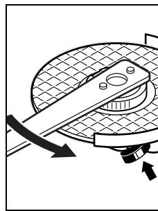
如果安裝正確，而且快速螺母未損壞的話，一般可以用手朝著逆時針的轉向擰松快速螺母。
