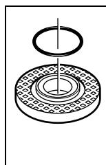
**Flens untuk poros kerja M 14:** Di dalam flens untuk poros kerja **10** di sekitar tingkatnya pemusatannya ada satu bagian dari bahan sintetik (ring-O). Jika ring-O tidak ada atau rusak, flens untuk poros kerja **10** mutlak harus digantikan, sebelum Anda melanjutkan penggunaan perkakas.
