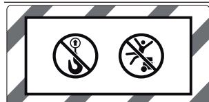
搬運時，請勿將吸塵器掛在起重機的掛鈎上。吸塵器不可用起重機吊運。可能會造成人員受傷或物品損壞。
