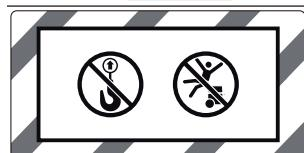
例如在运输途中切勿将吸尘器悬挂在吊车挂钩上。吸尘器不能用吊车吊运。有受伤和损坏的危险。
