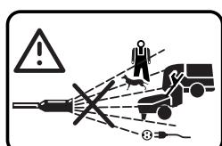
不可以把噴射出的水流朝向人、動物、機器或電動零件。
