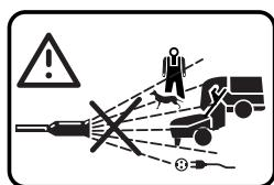
อย่าเล่นลำน้ำที่ฉีดออกมาก พุ่งตรงไปยังคน สัตว์ เครื่อง หรือชิ้นส่วนไฟฟ้า อย่างเด็ดขาด
