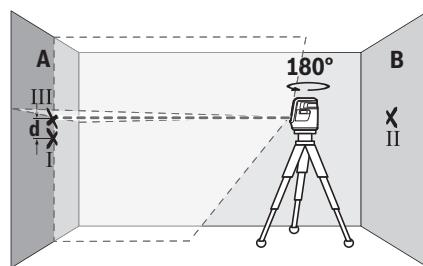
– Xoay dụng cụ đo 180° mà không thay đổi chiều cao. Hãy hướng nó lên tường A sao cho tia laser đó đi qua điểm đã đánh dấu I. Hãy để dụng cụ đo cân bằng và đánh dấu điểm giao nhau của tia laser trên tường A (điểm III).
